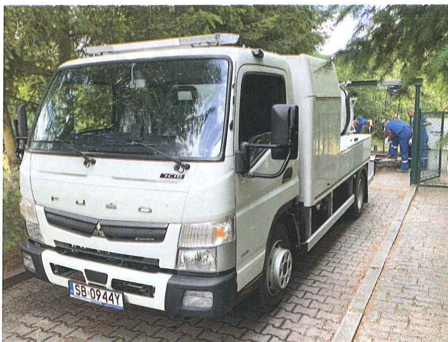
Zdj. Samochód z urządzeniem ssąco-płuczącym podczas prac serwisowych pompowni ścieków P-1
